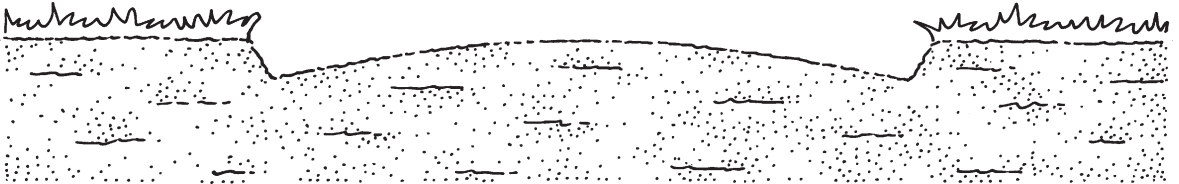
Figuur 3.16 Na het omspitten van het perk wordt de grond bolvormig geharkt. De randen langs het gazon dienen voldoende diep te worden gehouden, om deze te kunnen knippen.
