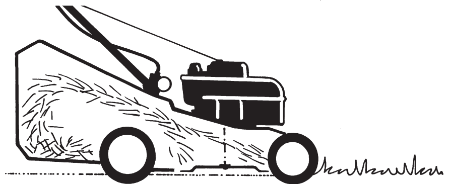
Figuur 3.16 Het gemaaide gras wordt bij deze cirkelmaaier achterwaarts afgevoerd en opgevangen in een vangbak.
